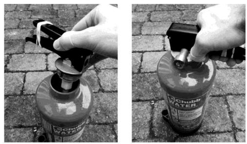
LAY THE CYLINDER FLAT (YOU MIGHT ALSO WANT TO FIRST PLUG THE HOSE CONNECTOR POINT TO STOP LIQUIDS LEAKING OUT). GRIP THE CYLINDER WITH ONE HAND AND WITH THE OTHER PUSH DOWN ON THE OPERATING LEVERS TO TIGHTEN THE VALVE ASSEMBLY FURTHER. IF YOU FIND THIS DIFFICULT THEN CAREFULLY STRIKE THE LEVERS WITH A RUBBER MALLET INSTEAD, BUT TRY NOT TO.
