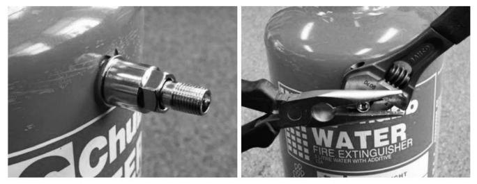
PUT THE VALVE CAP BACK ON BY WINDING IT CLOCKWISE. WHEN EVENTUALLY PRESSURISED, FURTHER TIGHTEN THE CAP WITH PLIERS. IT IS A SECONDARY DEFENCE AGAINST AIR/LIQUID LEAKS. THE MODIFICATION IS NOW COMPLETE.
