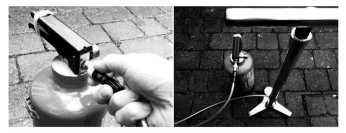
PUMP AIR INTO THE EXTINGUISHER AS FAR AS YOU CAN UP TO THE MIDDLE OF THE GREEN ZONE ON THE PRESSURE GAUGE (NORMALLY AROUND 220PSI / 15 BAR). 200 PSI / 14 BAR IS ENOUGH TO CREATE A POWERFUL JET THROUGHOUT THE WHOLE DISCHARGING PROCESS. BELOW THAT, THE JET WILL EVENTUALLY LOSE POWER AND REACH BEFORE BEING FULLY DISCHARGED.
